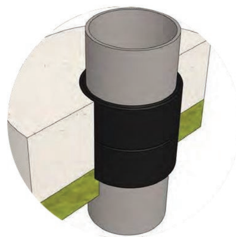
Taśma FP302 Intustrap wewnątrz zaprawy FR230 Intucompound, zapewniająca zapotrzebowanie na rozszerzanie cieplne rury - do EI240
